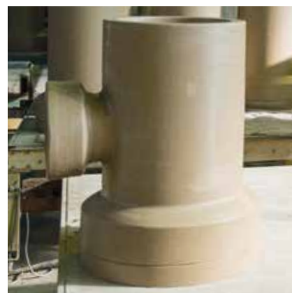
KeraBase 90°-os ágidom gyártása
