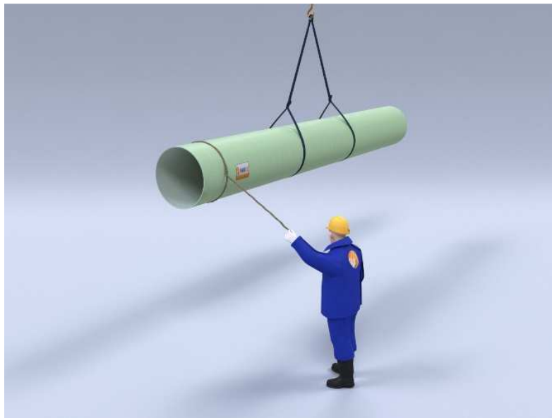
2.2 3: Cső emelése két alátámasztási ponttal és mozgatusa vezetőkötéttel
