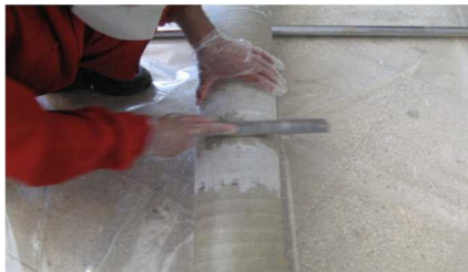
5.29 ábra: A csomók eltávolítása reszeléssel
