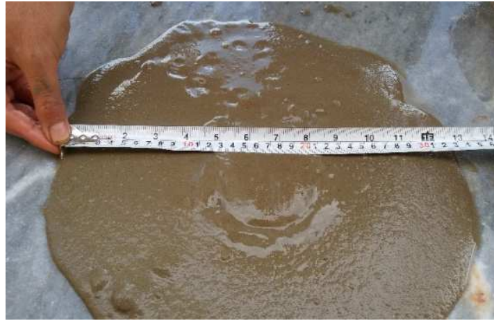
4.4 8: Cementtel stabilizált talaj folyásteresztje az ASTM D6103 szabvány szerint
