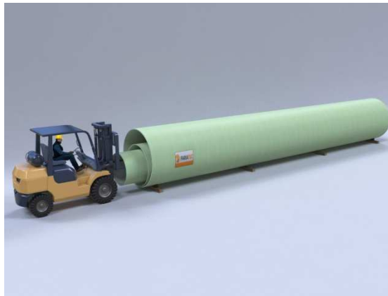
2.2 4: A csövek szétszedése emelőtargonccal
