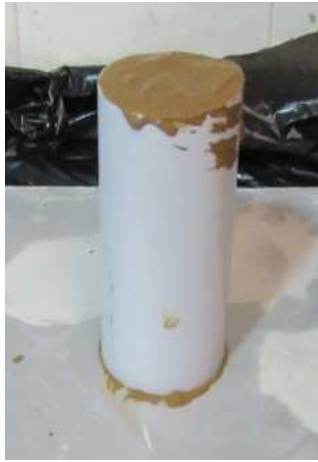
4.4 8: Cementtel stabilizált talaj folyásteresztje az ASTM D6103 szabvány szerint
