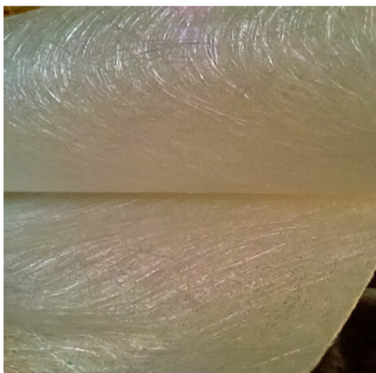
5.20. ábra: Részletek egy csőből, amelynek rétegei tompa-csavarodó illesztésben átfedik egymást:
