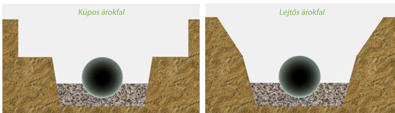
3.5. ábra: Tipikus módszerek az árokfal stabilizálására
