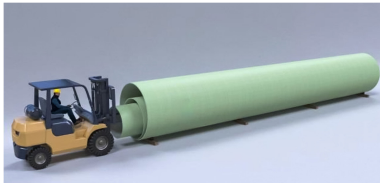
2.7. ábra: A csövek szétválasztása targoncával
