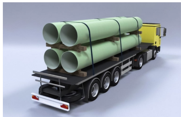
2.1. ábra: A csövek helyes szállítása kötegekben
