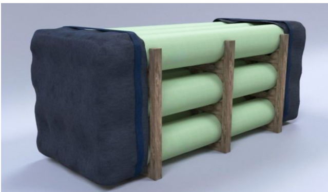
2.2. ábra: Kis DN-ű csövek kötegelése
