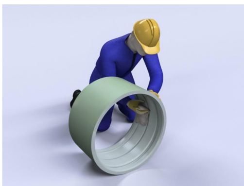
5.10. ábra: A horony tisztítása a tömítés behelyezése előtt
