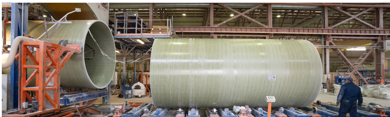
1.3. ábra: A kész ROREX csövek vágása a kívánt méretre
